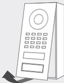
Ziehen Sie die Frontplatte mit der elektrischen Haupteinheit aus dem Montagerückgehäuse heraus.
